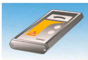
Pomiar wilgotności podłoża. Wymagana wilgotność: < 4% wagowo. Przyrząd, np. Sika Tramex.
