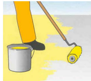
Równe nanoszenie materiału gruntującego Sikafloor®-144 / -161 wálkiem futrzanym ze średnim lub długim włosiem lub szczotką.
